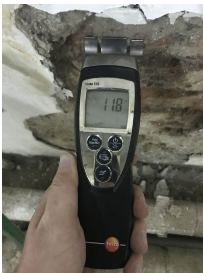
foto /20/ Vlhkost stěny 11,8 % ve výšce 0,5 m nad podlahou
