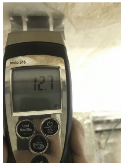
foto /21/ Vlhkost stěny 12,7 % ve výšce 2,5 m nad podlahou
